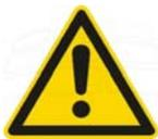
**Ne jamais ouvrir ou desserrer le couvercle d'un récipient ou des raccords de tuyaux lorsque ceux-ci sont sous pression. Toujours dépressuriser le récipient ou l'appareil au préalable.**
